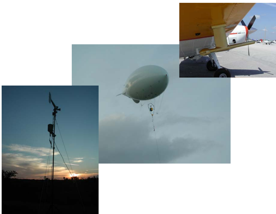
Figure 3.9 Équipements météorologiques pour les essais aériens incluant une tour au sol, un ballon dirigeable équipé d'une station météo (Kitoon) et un système météo monté sur un avion (AIMMS-20)
